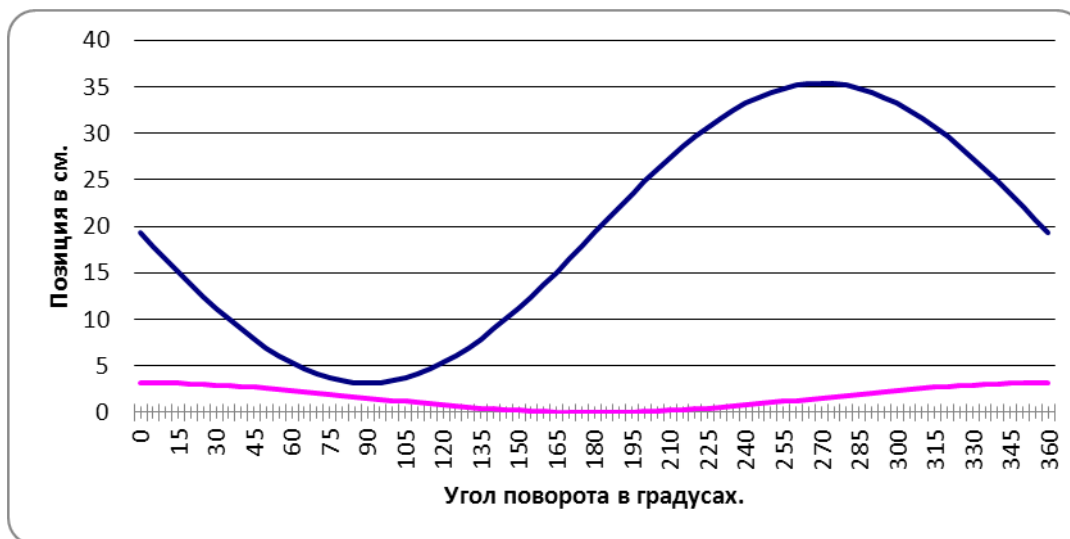
Рисунок 2 - Поршневые позиции для ДС (верхняя часть поршневого двигателя и дно вытеснителя).
